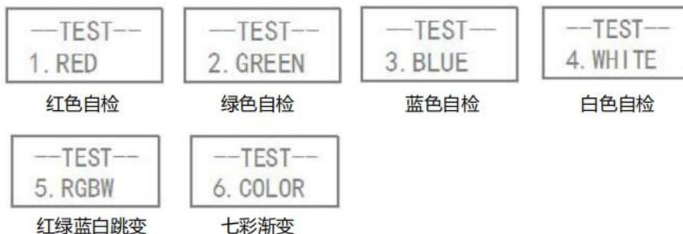
注：自检过程中，依次按 **TEST** 即可切换多个自检模式。
